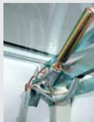
Otomatik açma için termik tetikleme
